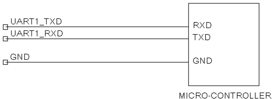
图 5-1 UART 接口与微处理器相连参考设计图
